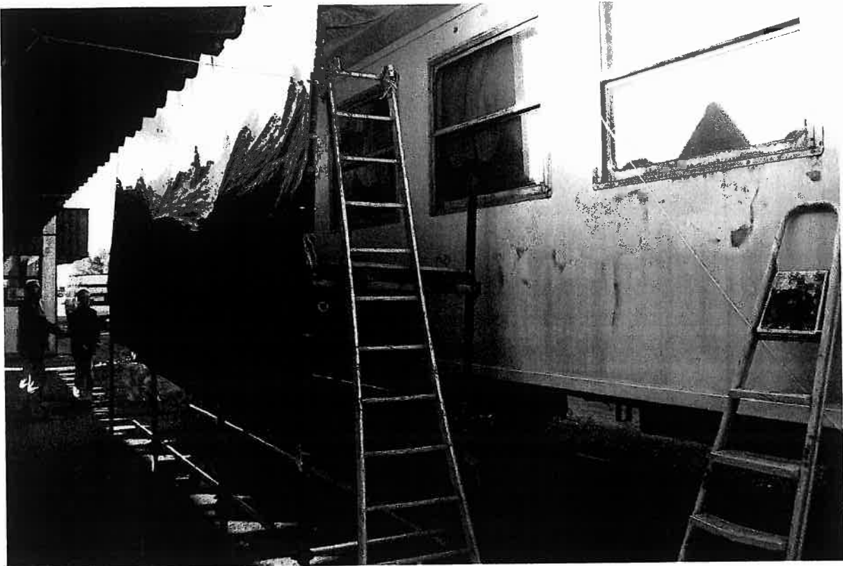
Schilderwerken aan het K3b rijtuig fase 1. De stelling is geplaatst en afdekzeil opgegaan de werken kunnen beginnen.
